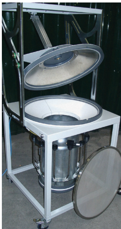
Bild 6: Ultraschallsieb mit Fluidbehälter für Venturiförderung
