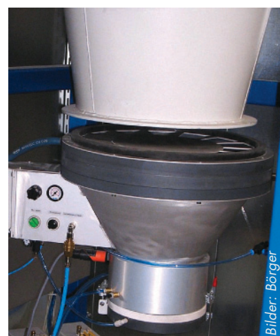
Bild 4: Ultraschallsieb mit Fluidbehälter und Dichtstrom-Pumpentechnik (System Cyclomat „light“)
