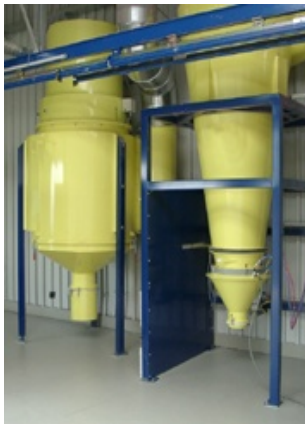
Zyklonfiltersystem als Nachfilter für eine Zyklonrückgewinnung mit Cyclomat
