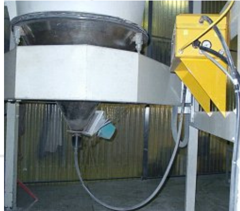
dIP 12 – Pumpe als Transferpumpe für die Zyklonrückgewinnung
