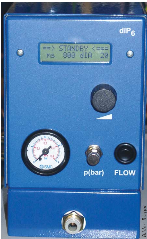
Die Pulvermengeneinstellung von 20 bis 350 g/min – einfach und übersichtlich
