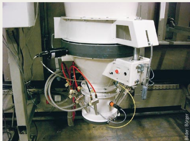
Nachher: Das Ultraschallsieb mit Fächerscheibe, integriertem Fluidbehälter und Entleerungsklappe
