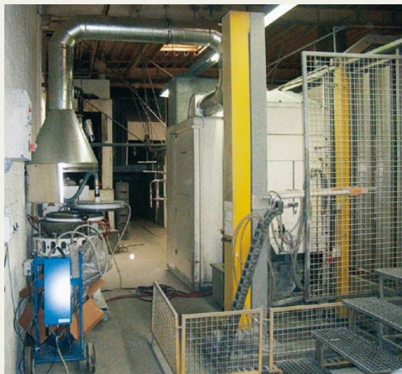
Bis zu 15 Prozent Pulver spart der Lohnbeschichter P+F seit der Installation der Ultraschallsiebtechnik
