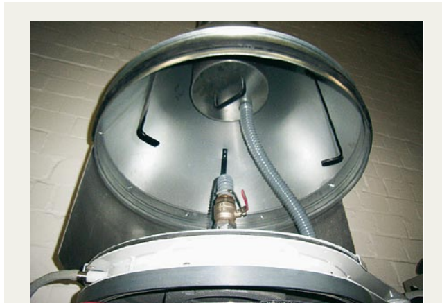
Einfache Lösung, große Wirkung: die Absaughaube mit integrierter Staubabsaugung
